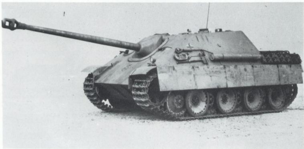
Figura 9: Caça-tanques construído sobre a plataforma Pantera. Veículo construído para dar mobilidade ao canhão antitanque de 88 mm. [4]
