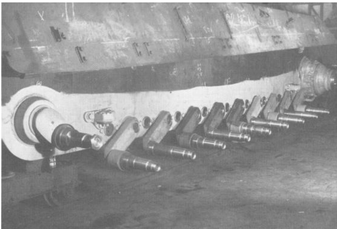
Figura 24: Braços da suspensão por barras de torção da plataforma Tigre da Henschel. [17]
