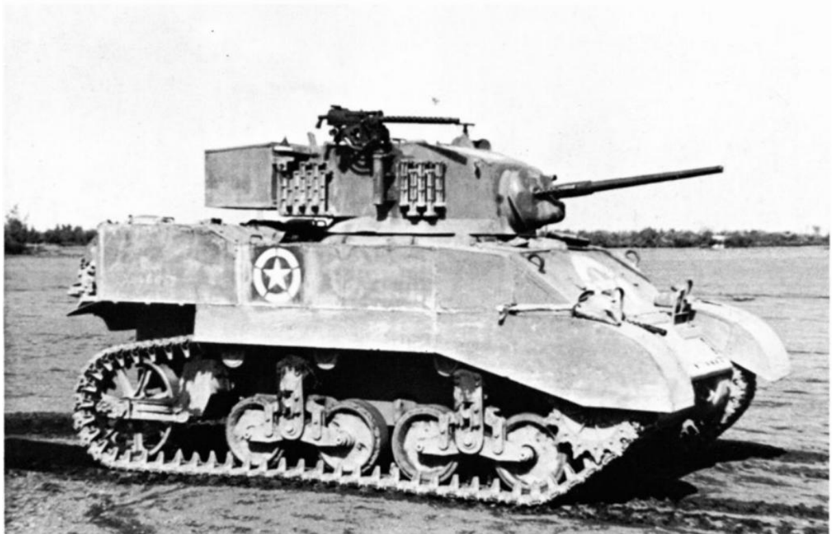
Figura 21: Tanque leve General Stuart M5. As rodas de apoio estão em braços independentes, mas compartilham a mola. [9]
