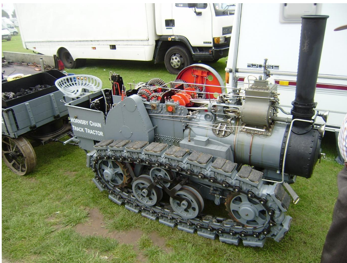
Figura 4: Trator patenteado pela Hornsby & Sons of Grantham . [102]
