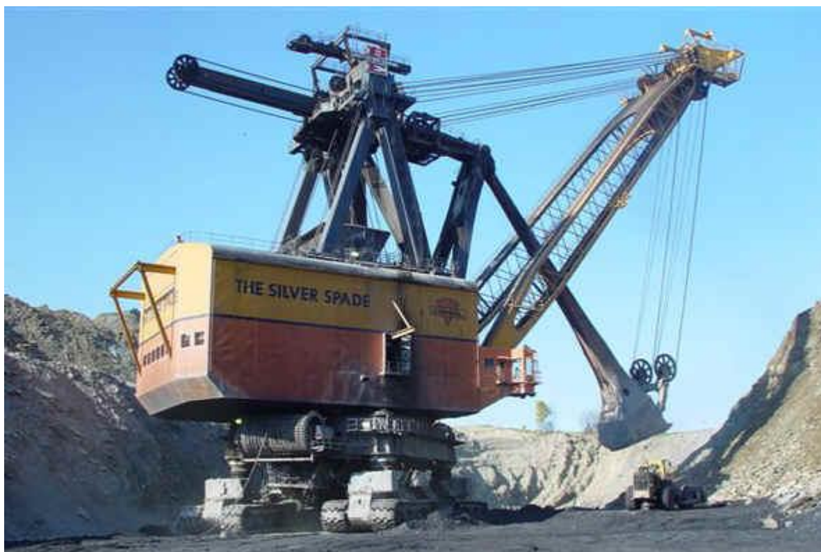
Figura 10: Silver Spade, a maior escavadeira feita pela Bucyrus. [109]
