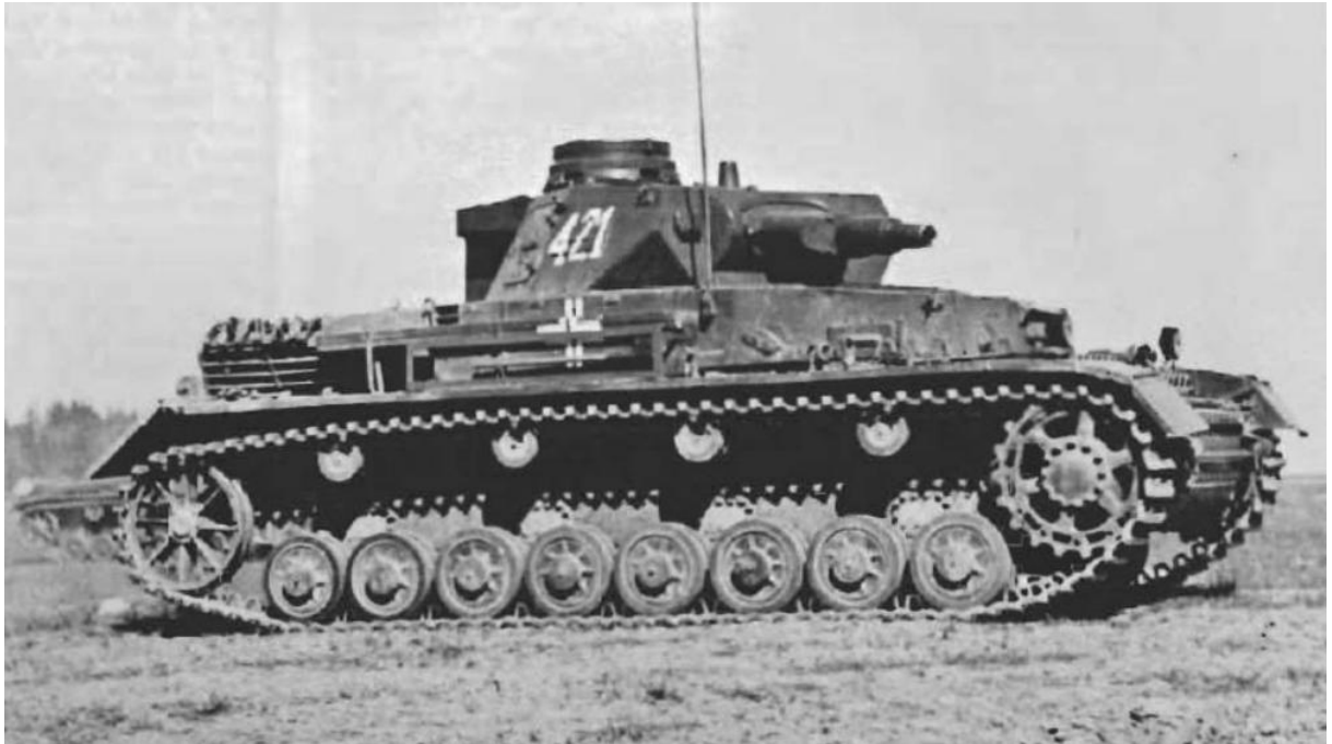
Figura 29: Tanque Panzer IV Ausf B, rodas de apoio pequenas e rodas de retorno na parte superior da lagarta. [11]
